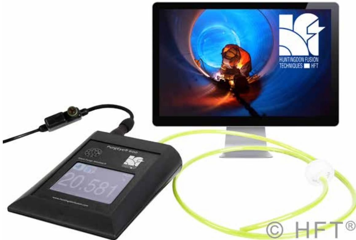
**El Weld Purge Monitor® (monitor de purga de soldadura) con pantalla a color computarizado PurgEye® 600 que mide desde niveles de oxígeno atmosférico hasta 1 ppm. ¡El instrumento «Todo en uno»!**
